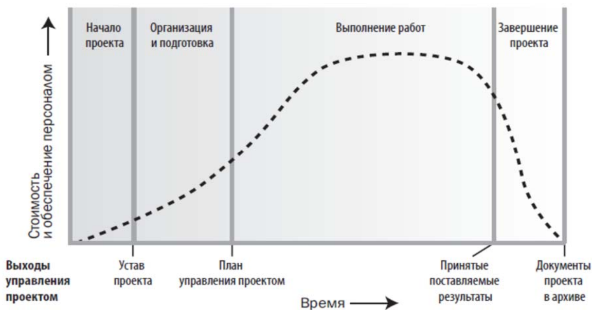
Рис. 1.2. Взаимосвязь структуры жизненного цикла проекта со стоимостью и обеспечением персоналом проекта
