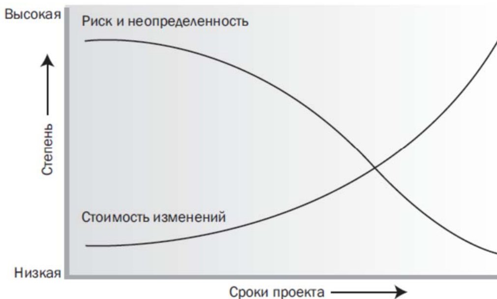
Рис. 1.3. Зависимость риска и неопределенности и стоимости изменений проекта от времени до завершения проекта
